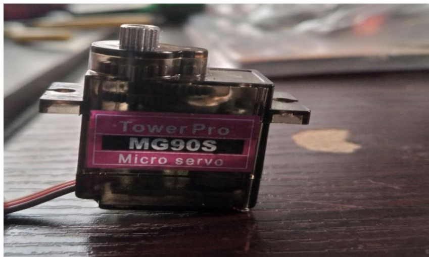
Figure 9: Metallic servo motor [28]
